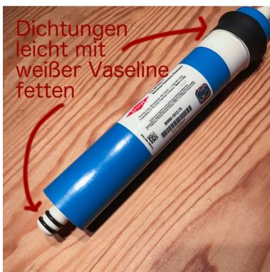
Bei der neuen Membran wird der große schwarze Dichtring dünn mit weißer Vaseline gefettet. Die beiden kleinen Dichtringe am Reinstwasserrohr werden ebenfalls dünn mit Vaseline bestrichen.
