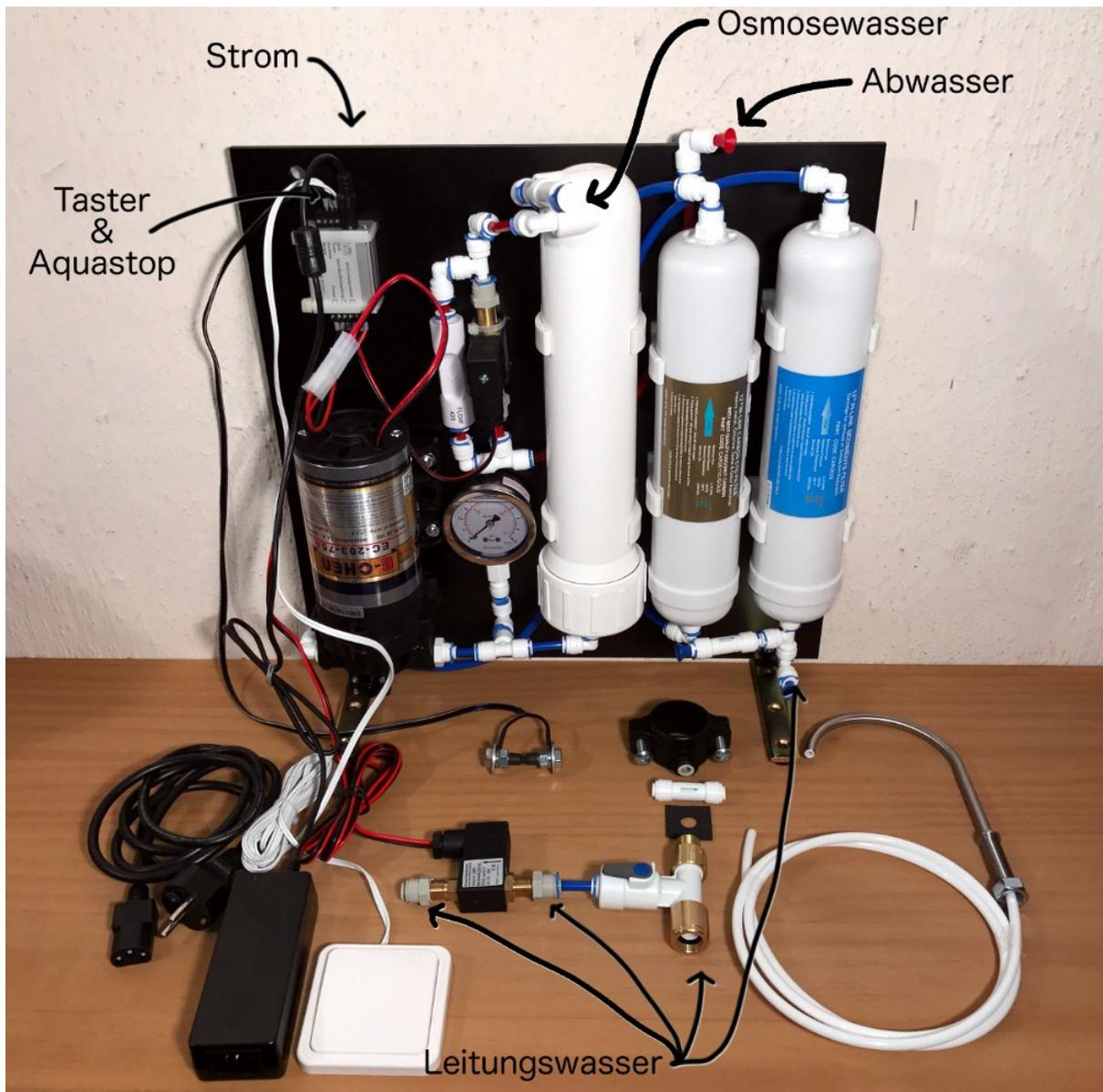
Für die Wasseranschlüsse des Aquamichel Automatik werden PE Schläuche in 3 Farben verwendet. rot = Abwasser, blau = Leitungswasser oder vorgefiltertes Leitungswasser, weiß = Reinwasser / Osmosewasser.
