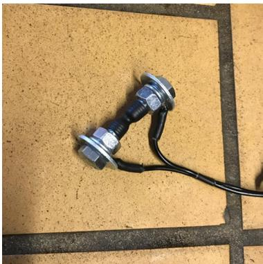
Der Aquastop Sensor soll erkennen, wenn irgendwo durch Defekt oder Fehlfunktion unerwünscht Wasser austritt. Er wird am besten dort auf den Fußboden gelegt, wo in so einem Fall als erstes eine Wasserpfütze zu erwarten ist. Wichtig ist, das beide Seiten vom Sensor auf dem Boden aufliegen. Denn austretendes Wasser wird nur dann erkannt, wenn beide Seiten in der gleichen Pfütze liegen und mit dem Wasser in Berührung sind.
