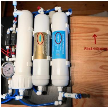
Die neuen Vorfilter werden in die weißen Clipse gedrückt. Dabei ist unbedingt die auf dem Kartuschenetikett gekennzeichnete Fließrichtung zu beachten. Wenn der Filter senkrecht auf den Füßen steht, muss die Fließrichtung immer von unten nach oben gehen. Die Winkelverbinder werden mit leichtem Druck in die entsprechenden Verbinder der
