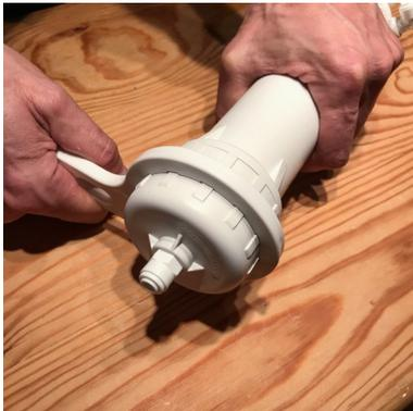
Das Membrangehäuse wird fest mit der Hand gehalten um dann den Deckel des Membrangehäuses mit dem dafür vorgesehenen Schlüssel zu öffnen.
