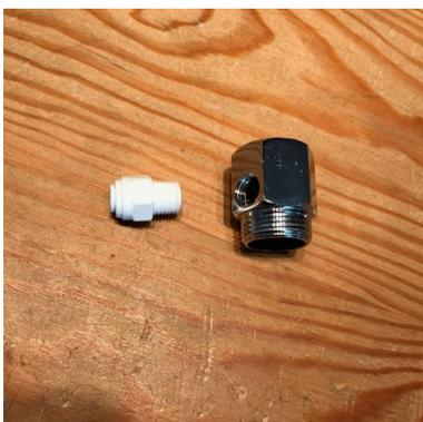
Dieser Adapter wird aus mehreren Einzelkomponenten zusammen gesetzt. Der weiße 1/4" Einschraubverbinder muss mit Teflonband abgedichtet in den 3/4" Adapter eingeschraubt werden.
