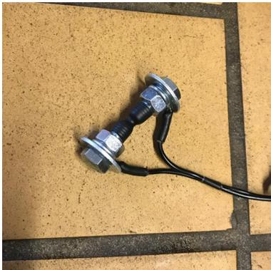
Wenn irgendwo ungewollt Wasser austritt und der am Boden liegende Aquastop Sensor nass wird, erkennt die Steuerung den Fehler und schlägt Alarm. Als erstes werden alle Magnetventile geschlossen und die Pumpe abgeschaltet, damit kein weiteres Wasser austreten kann. Dann ertönen in regelmäßigen Abständen Beeps. Drei kurze, drei lange und nochmal 3 kurze und dann eine Pause. Das ist der Morsecode von SOS, den Schiffe in Seenot früher gesendet haben :-)
