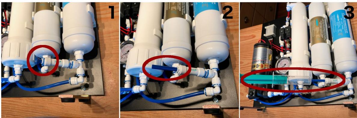
Dann wird mit der Einwegspritze und einem kleinen Stück Schlauch 40 ml Wasserstoffperoxid 3% über das Rückschlagventil am Eingang des ersten Vorfilters in den Filter gespritzt. Anschließend werden 20 ml Leitungswasser auf dem selben Weg hinterher gespritzt, damit kein Wasserstoffperoxid im
