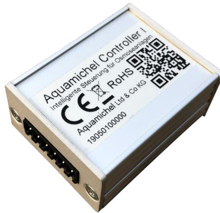
Die Microcontroller Steuerung Aquamichel Controller I ist eine kleine minimalistisch aufgebaute Steuerung für Direct Flow Umkehrosmoseanlagen. Teil des minimalistischen Designs ist ein einfaches Bedienkonzept mit nur einem einzigen Tastschalter.
