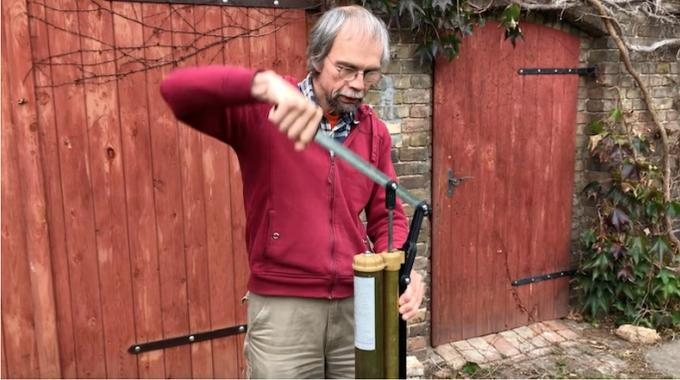
Nun kann man den Aquamichel Mini an der Handpumpe anschließen und Wasser filtern. In diesem Video zeigen Jan und ich wie das geht:
