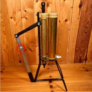
Der Handbügel ist für den Transportzweck nicht mit der Kolbenstange verbunden. Die dafür nötige Schraube befindet sich am Handbügel (im Bild rot markiert) oder in einem separatem Teilebeutel.
