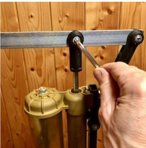
Der Handbügel wird dann in die Gabel der Kolbenstange eingeführt und mit der Inbusschraube fixiert (nur leicht anziehen). Dafür wird ein Inbusschlüssel Größe 6 benötigt.
