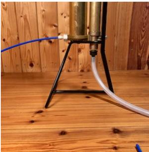
Der  $\frac{1}{4}$ " - Schlauch kann direkt in den Schlauchverbinder am Pumpenausgang eingesteckt werden. Das andere Ende führt später zum Wassereingang des Aquamichel Mini. Eine zusätzliche Absicherung mit blauen Sicherungsclipsen ist bei diesen Schlauchverbindungen nicht zwingend erforderlich. Wie solche Schlauchverbindungen hergestellt und wieder gelöst werden können zeigt dieses Video:
