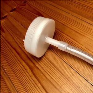
Das andere Ende des Ansaugschlauches wird mit dem Ansaugkorb verbunden.
